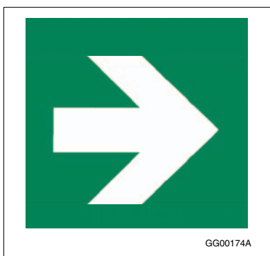
Figure A-3.4.5.1. 2)c)-B « Flèche directionnelle à 90 degrés » (E005), symbole extrait de la norme ISO 7010
