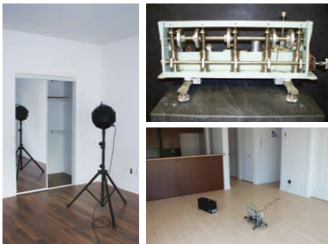
Voici un exemple de l'appareillage (génératrice d'impact et sonomètre) utilisé pour effectuer un test acoustique dans deux pièces superposées.
